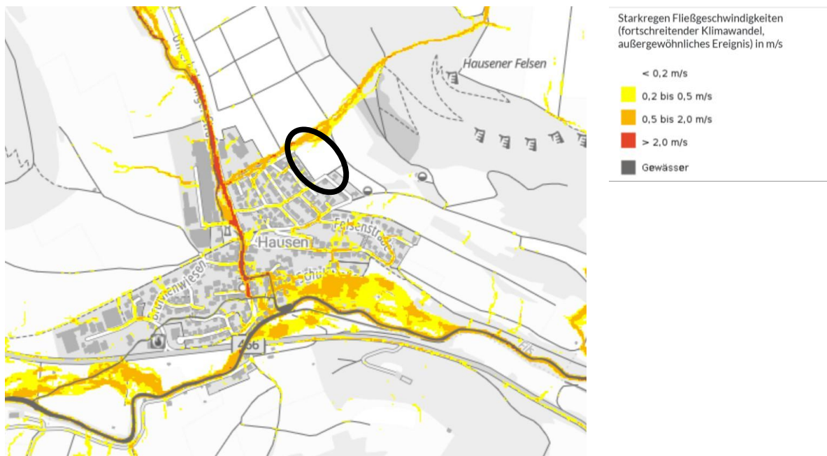
Abb. 2: Abflussbahnen, Quelle: Digitaler Klimaatlas Region Stuttgart, Abfrage 12/2025
